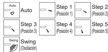
Seleccione "Swing" (Oscilación) para que los álabes se muevan hacia arriba y hacia abajo automáticamente.
