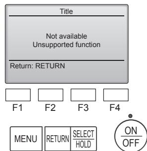
Le message à gauche s'affiche si l'utilisateur sélectionne une fonction non prise en charge par le modèle d'appareil intérieur considéré.
