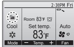
Cuando se muestra en la pantalla principal en el modo Completa, el sistema está controlado a nivel central y no se puede restaurar la señal.
