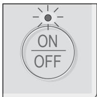
Presione el botón [ON/OFF]. La lámpara de ENCENDIDO/APAGADO se iluminará en verde y comenzará a funcionar la unidad. Cuando "LED lighting" (Iluminación LED) está ajustada en "No", la lámpara de ENCENDIDO/APAGADO no se encenderá.
