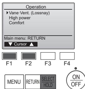
Sélectionnez "Vane-Vent. (Lossnay)" (Ailette·Vent. (Lossnay)) dans le menu Operation (Fonctionnement) et appuyez sur la touche [SELECT/HOLD] (SÉLECTIONNER/CONSERVER).
