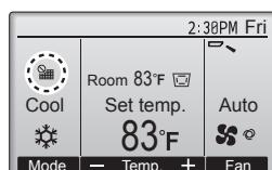
Lorsque le █████ est affiché sur l'écran principal en mode complet, le système est piloté de façon centralisée et le témoin d'état du filtre ne peut pas être remis à zéro.
