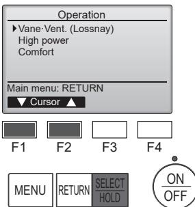
Seleccione "Vane-Vent. (Lossnay)" (Lama-Vent. (Lossnay)) desde el menú Funcionamiento y pulse el botón [SELECT/HOLD] (ACEPTAR/RETENER).
