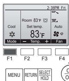
Chaque pression sur la touche [F1] fait défiler les modes de fonctionnement suivants. Sélectionnez le mode de fonctionnement désiré.
