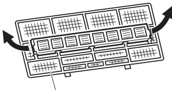
Tirez sur le panneau frontal pour le retirer du filtre à air
