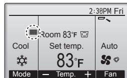
████ apparaît sur l'écran principal dans en mode complet quand les filtres doivent être nettoyés.
