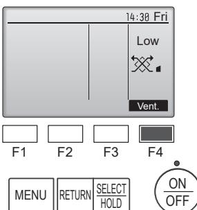
Presione el botón [F4] para pasar por las opciones de configuración de la ventilación en el siguiente orden: "Off" (Apagado), "Low" (Baja) y "High" (Alta).
