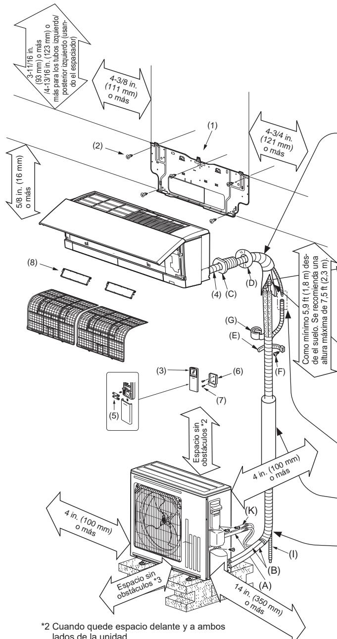
Utilice el manguito del orificio de la pared (C) para impedir que los cables de conexión interiores/exteriores (A) estén en contacto con las piezas metálicas de la pared y para proteger el cableado de los roedores.
