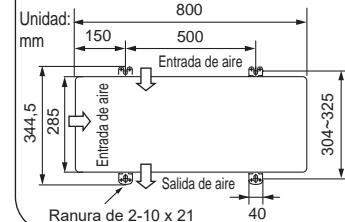
**Instalación de la unidad exterior (FX15, 18, 24)**
