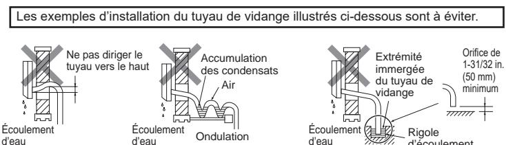
Les exemples d'installation du tuyau de vidange illustrés ci-dessous sont à éviter.
